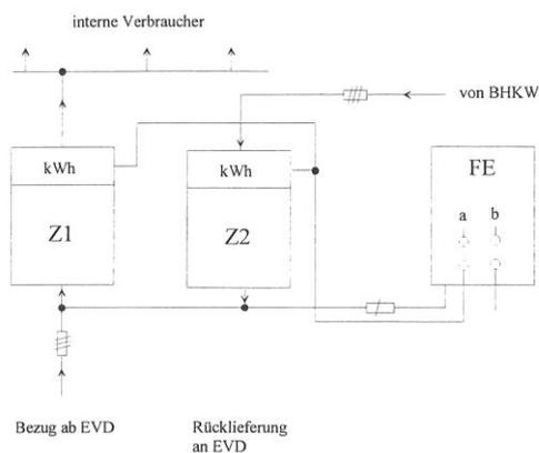
Z1 Zähler amtl. geprüft mit Rücklaufsperrung für Bezug ab EV Dintikon dient für die Aufteilung der kWh in HT und NT
